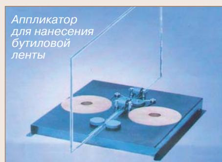
Бутиловую ленту можно наносить как вручную, так и с использованием автомата. Дистанционная рамка протягивается через прижимные валики, и лента наносится и обжимается одновременно. Автомат обеспечивает легкость нанесения, значительно сокращает время процедуры и повышает качество изделия. Работает с рамками шириной от 6 до 24 мм.
